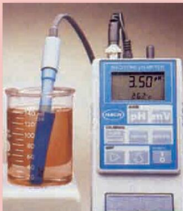
Một loại máy đo pH được dùng trong phòng thí nghiệm
